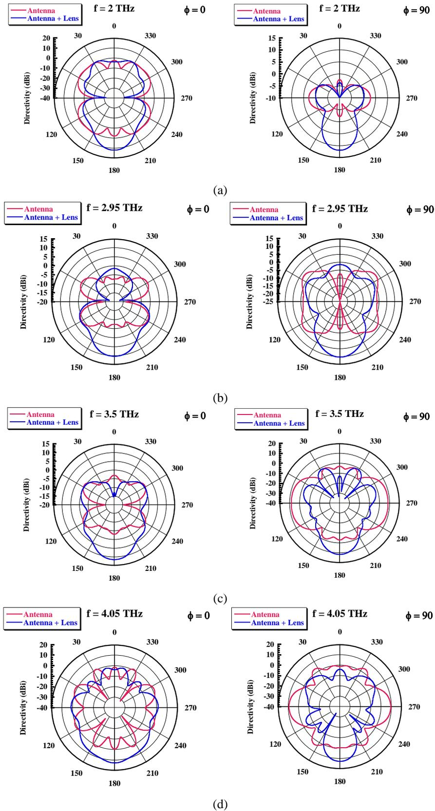
Fig. 15. 2D radiation pattern for  $R_L = 80 \mu\text{m}$ : (a) 2 THz, (b) 2.95 THz, (c) 3.5 THz, and (d) 4.05 THz.
