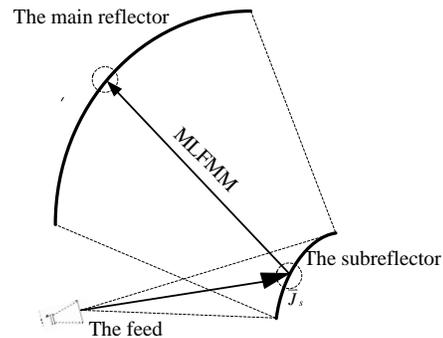
Fig. 2. Dual offset reflector antenna.
